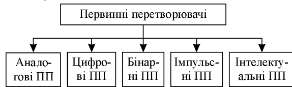
Рис. 3. Класифікація ПП за типом вихідного сигналу
