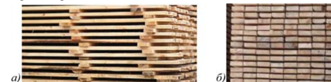
Рис. 2. Фрагменти поверхонь штабелів пиломатеріалів: а) з утворенням зазорів між шарами; б) без утворення зазорів (торцева поверхня штабеля)
