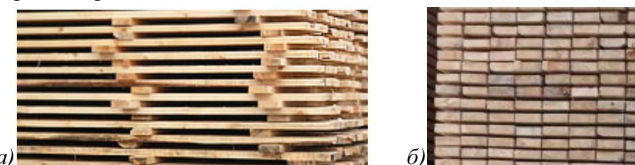
Рис. 2. Фрагменти поверхонь штабелів пиломатеріалів: а) з утворенням зазорів між шарами; б) без утворення зазорів (торцева поверхня штабеля)
