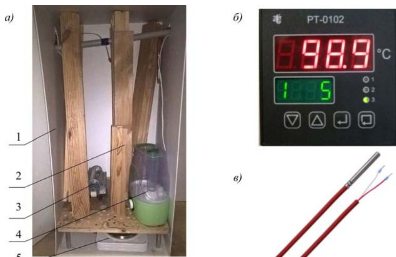
Рис. 1. Світлина кліматичної камери та її окремих елементів: а) загальний вигляд кліматичної камери (з відкритою передньою дверкою): 1) корпус; 2) експериментальний взірець; 3) вентилятор; 4) зволожувач повітря; 5) нагрівальний елемент (ГЕН); б) регулятор температури та вологості РТ-0102; в) датчі вологості та температури
