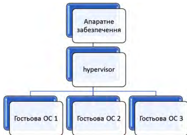
Рис. 1. Модель керування роботою VM з допомогою hypervisor
