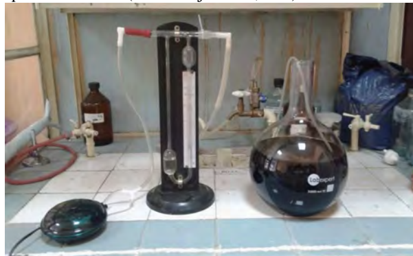
Рис. 1. Схема експериментальної установки для дослідження аеробного очищення фільтрату
