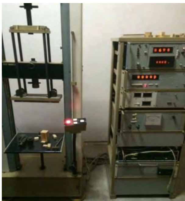
Рис. 3. Розривна машина IP 5057-50
