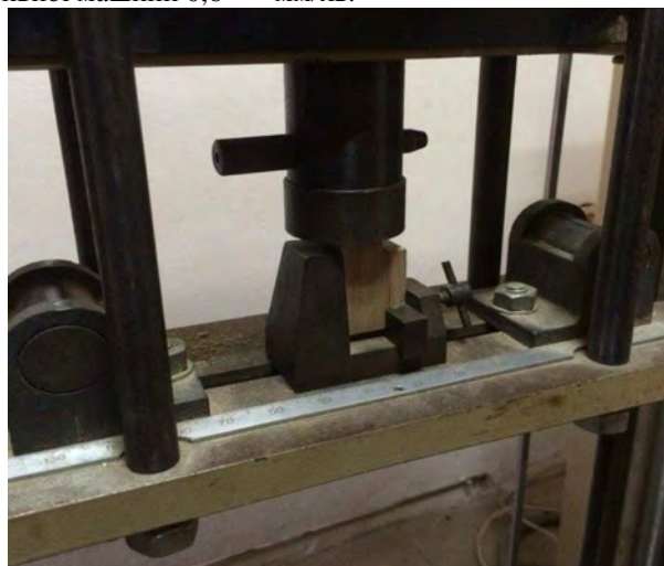
Рис. 4. Розміщення зрізка у пристосуванні в розривній машині
