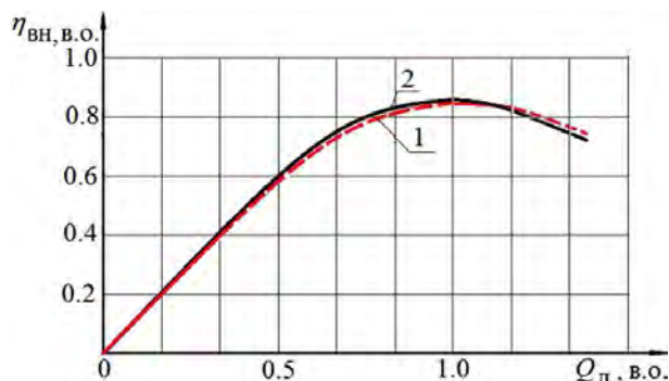
Рис. 5. Порівняння залежностей ККД \eta_{ВН} від витратного навантаження Q_{Д} магістрального насоса НМ 3600-230: 1 – розрахованої за допомогою моделі; 2 – отриманої експериментально (крива 2) (Kostyshyn & Kurlyak, 2015)
