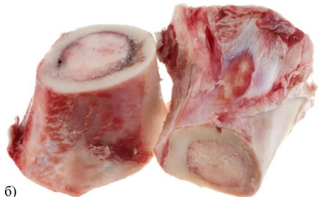
Рис. 2. Фотография поверхности разреза трубчатой кости водополимерной (а) и водоазотной (б) струями
