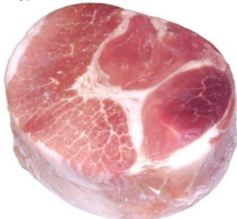
Рис. 1. Поверхность разреза водополимерной струей образца мяса свинины толщиной 0,25 м: t = -7^{\circ}\text{C} ; C_{\text{пэо}}=0,007 %, M_{\text{пэо}}=4 \cdot 10^{-6} ; \Delta P_o=100 МПа; d_o=0,35 \cdot 10^{-3} м; V_n=25 \cdot 10^{-3} м/с
