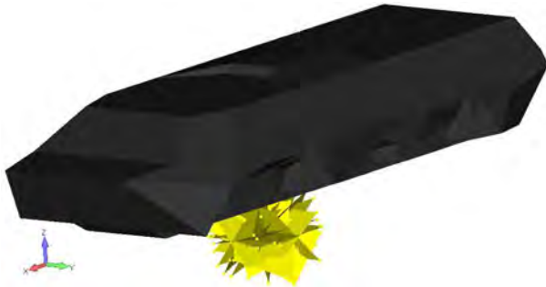
Рис. 9. Порівняння геометрії корпусів БТР-80 за класичною методикою (показано жовтим) та за поточною (темно-сірим)
