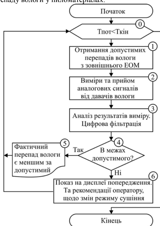
Рис. 2. Алгоритм роботи системи контролю перепадів вологи у пиломатеріалі
