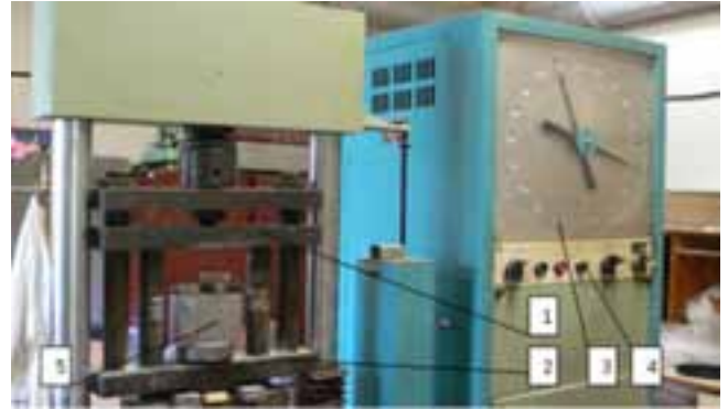
Рис. 2. Схема дослідної установки: 1) рухома плита; 2) опірня плита; 3) вимірювач сили; 4) пульт керування; 5) пристрій для пресування
