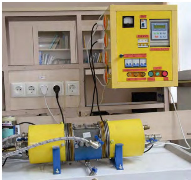
Рис. 1. Світліна низькочастотного електромагнітного кавітатора резонансного типу для кавітаційного оброблення води для поливу та зрошування сільськогосподарських культур (із частково знятими захисними елементами кожуха)
