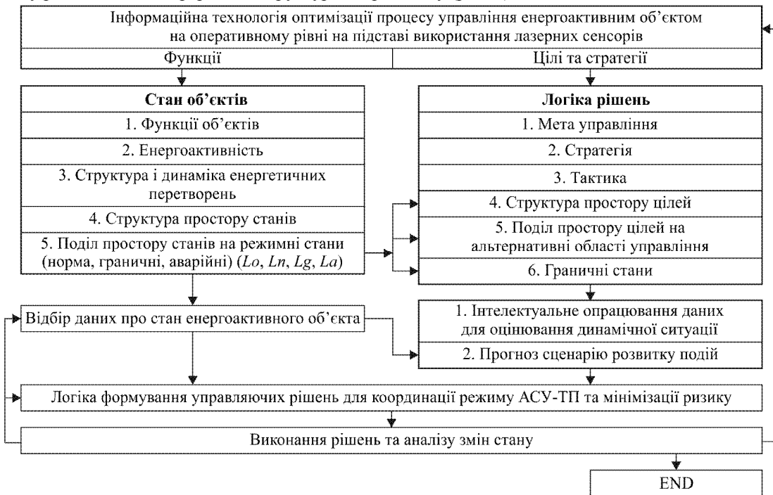
Рис. 9. Схема інформаційної технології відбору, опрацювання, інтерпретації даних забезпечення процесу управління режимом енергоблоку
