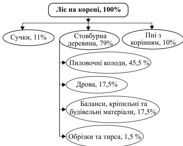
Рис. 2. Структура відходів деревної біомаси лісозаготівельного виробництва, яка може бути використана в енергетичних цілях (на основі джерела (Formation, 2008))
