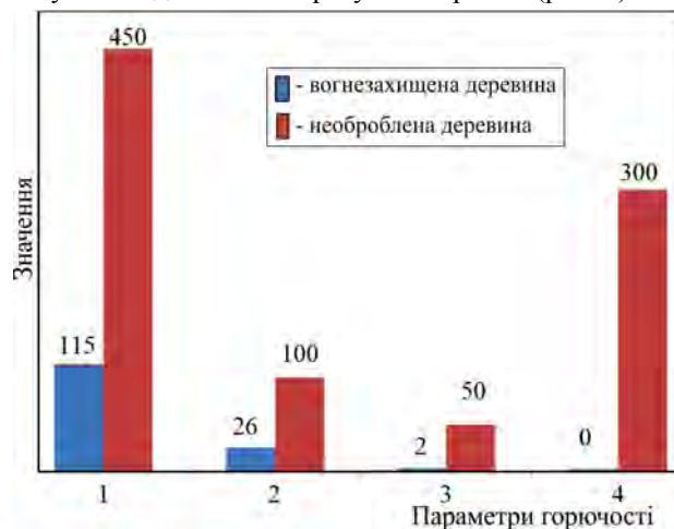
Рис. 4. Визначення групи горючості деревини згідно з (Tsapko, & Tsapko, 2017): 1) температура димових газів ( T , °C); 2) ступінь пошкодження зразків за довжиною ( S_L , %); 3) ступінь пошкодження за масою ( S_m , %); 4) тривалість самостійного горіння ( \tau , с)
