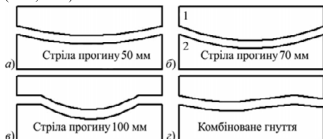
Рис. 3. Шаблиони для гнуття деревини: 1) матриця; 2) пуансон
