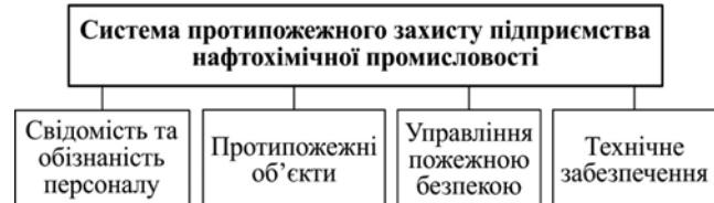
Рис. 2. Схема системи протипожежного захисту підприємства нафтохімічної промисловості (Zhang, Zhang, & Qian, 2018)
