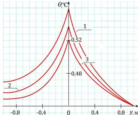
**Рис. 2.** Залежність температури  $\theta(x, y)$  від координати  $y$  для  $x = 0$  та заданих значень коефіцієнта тепловіддачі: крива 1 –  $\alpha_1 = \alpha_2 = 17,64$  вт/(м<sup>2</sup>·град); крива 2 –  $\alpha_1 = \alpha_2 = 15,74$  вт/(м<sup>2</sup>·град); крива 3 –  $\alpha_1 = \alpha_2 = 13,59$  вт/(м<sup>2</sup>·град)
