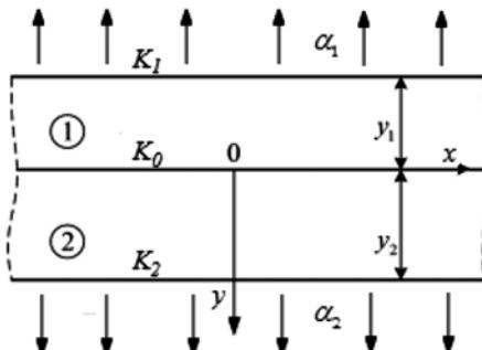
Рис. 1. Переріз ізотропної пластини з тепловіддачею площину  $z=0$
