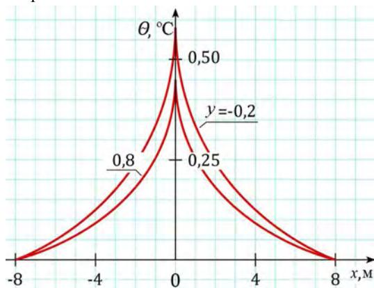
**Рис. 3.** Залежність температури  $\theta(x, y)$  від координати  $x$  для  $\alpha_1 = \alpha_2 = 16,92 \text{ вт}/(\text{м}\cdot\text{град})$  та заданих значень координати  $y$
