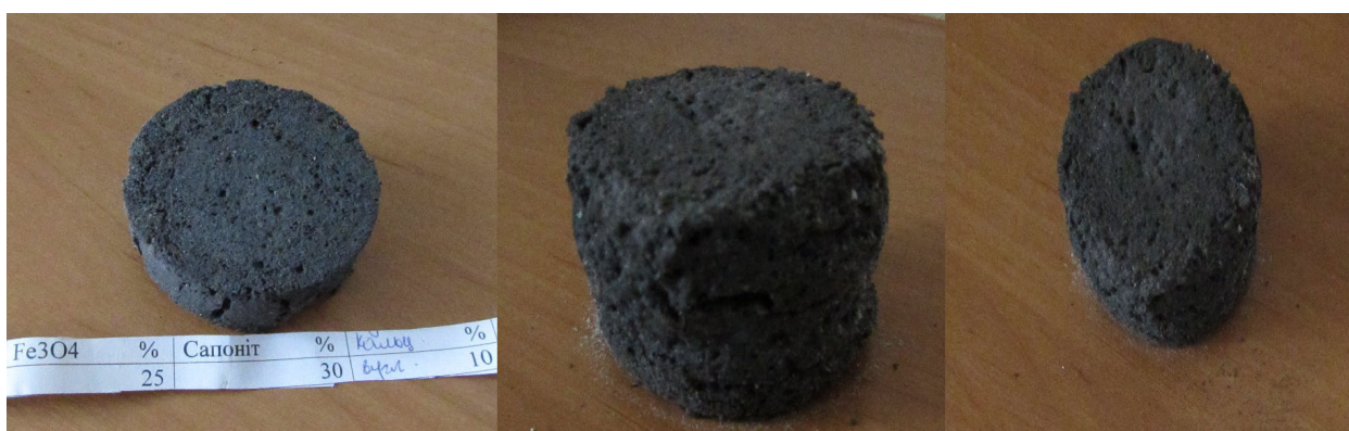
Рис. 2. Нова пориста прониклива кераміка отримана методом СВС
