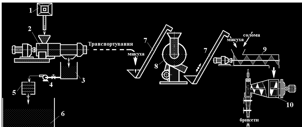
Рис.1. Технологічна схема лінії переробки насіння ріпаку звичайної якості з отриманням паливних брикетів.
