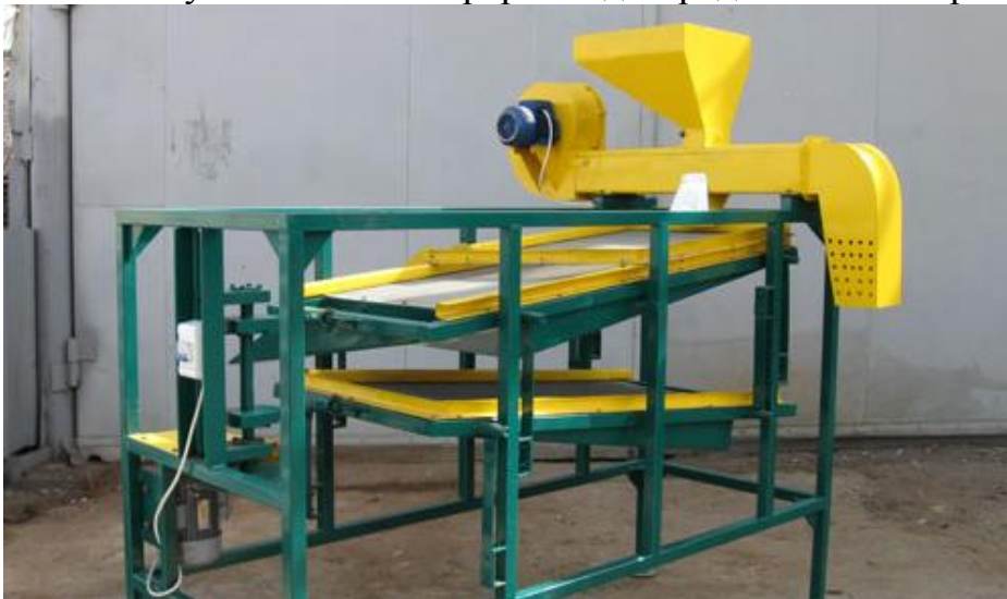
Рис. 4. Дослідно-промислова установка НВЧ знезараження комбікорму у псевдозрідженому шарі
