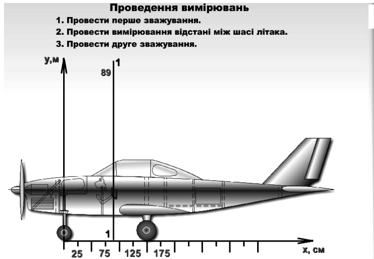
Рис.5. Вимірювання відстані між шасі літака
