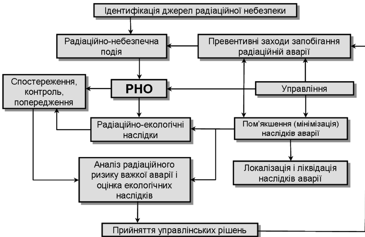
Рисунок 5 – Структурна схема контролю і керування радіаційними аваріями
