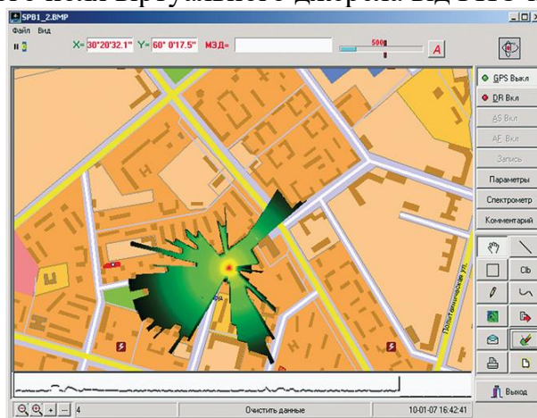
Рисунок 4 – Зображення радіаційного поля віртуального джерела від РНО
