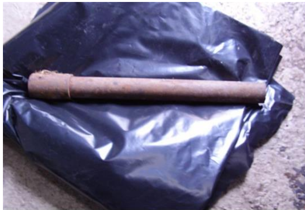
Рисунок 3 – фрагмент труби вагою 12 кг, забруднений радіоактивним матеріалом – ізотопом ^{226}\text{Ra}
