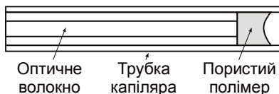
Рис. 7. Типова будова хімічного оптроду
