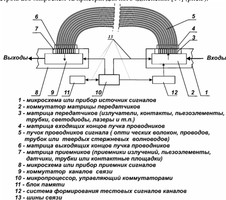
Рис.3. Спосіб з'єднання, що самовідновлюється багатоконтактних пристроїв або мікросхем та пристрій для його здійснення [14]
