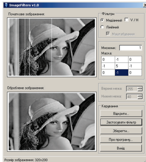
Рис. 8. Зображення після медіанної фільтрації в горизонтальному напрямі
