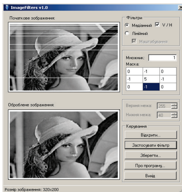
Рис. 9. Зображення після медіанної фільтрації у вертикальному напрямі
