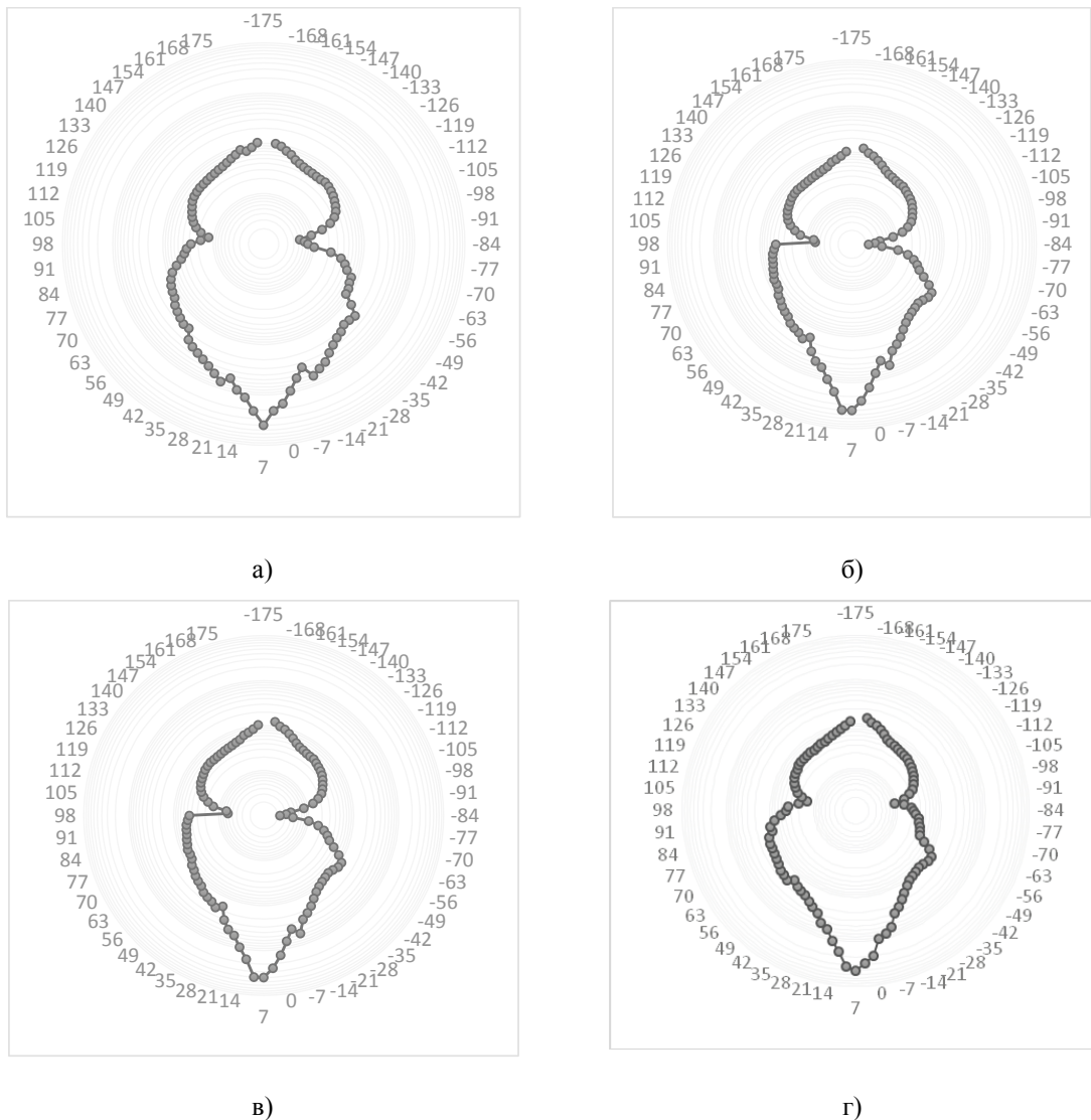
Рис. 5. Індикатриса розсіювання: а) 0^{\circ} — 180^{\circ} , б) 45^{\circ} — 225^{\circ} , в) 90^{\circ} — 270^{\circ} , г) 135^{\circ} — 315^{\circ} , для зразку грудини курки, товщиною 0,76 \pm 0,02 мм
