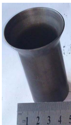
Рис. 7. Заготовки после раздачи: а – традиционным пуансоном; б – спрофилированным пуансоном
