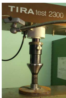
Рис. 6. Раздача на машине TIRA test 2300
