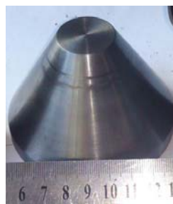
Рис. 5. Пуансоны: а – традиционный; б – спрофилированный
