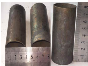
Рис. 4. Исходные трубчатые заготовки: а – из стали 12X18Н10Т; б – из стали 10
