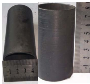
Рис. 4. Исходные трубчатые заготовки: а – из стали 12X18Н10Т; б – из стали 10
