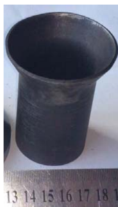
Рис. 7. Заготовки после раздачи: а – традиционным пуансоном; б – спрофилированным пуансоном
