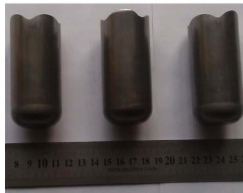
Рис. 9. Детали, полученные за один переход вытяжкой в матрице специального профиля
