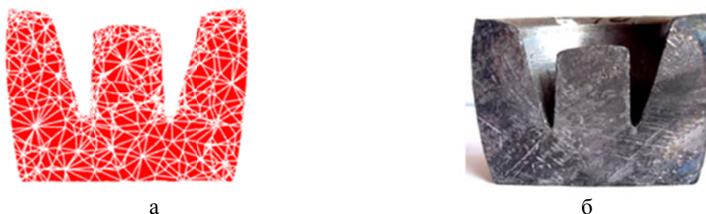
Рис. 3. Сравнение геометрии полученных образцов после 1-го стадии: а – вид образца, полученный математическим моделированием; б – экспериментально полученный образец
