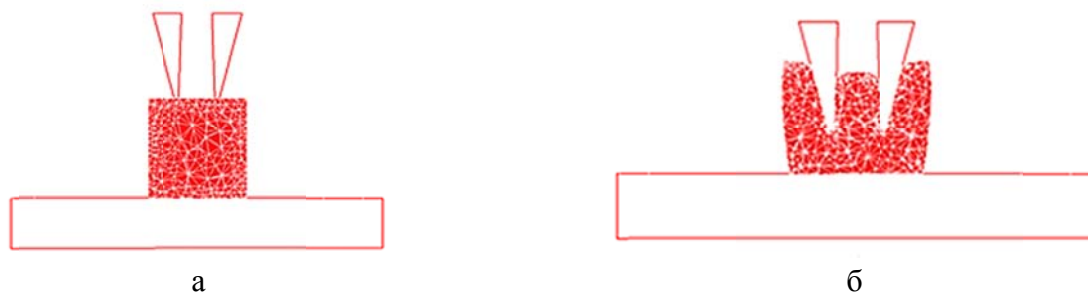
Рис. 2. Математическое моделирование внедрения «врезного кольца»
