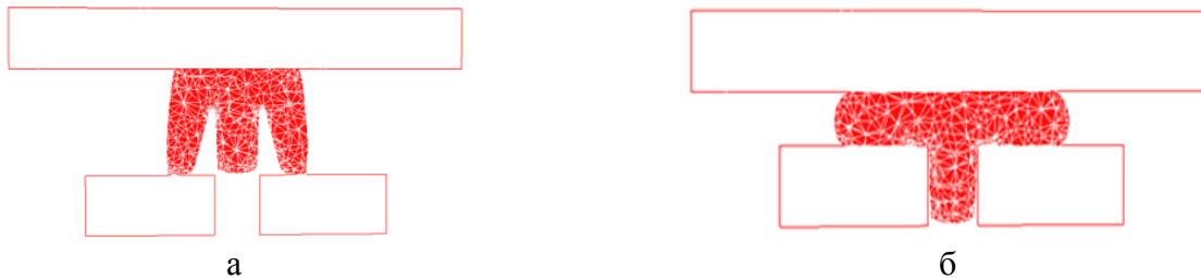
Рис. 5. Математическое моделирование осадки полученного образца в подкладном кольце
