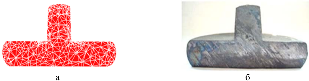
Рис. 6. Сравнение геометрии полученных образцов после 2-го стадии: а – вид образца полученного математическим моделированием; б – экспериментально полученный образец
