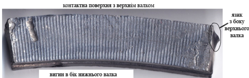
Рис. 7. Бічна поверхня передньої частини штаби після прокатування
