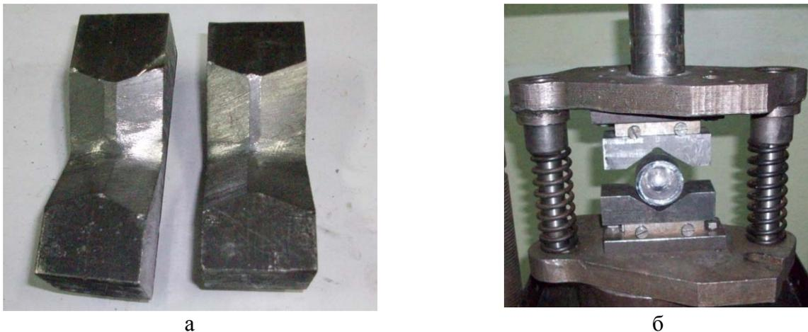
Рис. 1. Бойки (а) и оснастка для протяжки (б)
