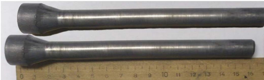
Рис. 2. Ствольные заготовки, полученные путём гидроэкструзии на гладкой оправке
