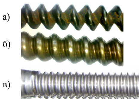
Рис. 1. Фотографии оправки и труб (а), полученных с оправкой (б) и без оправки (в)
