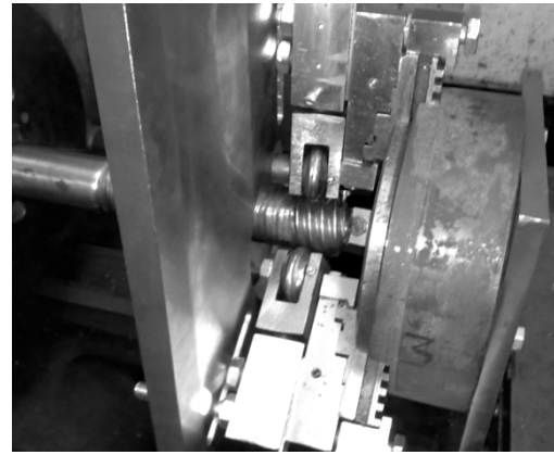
Рис. 4. Трехроlikовая обкатная головка, которая установлена на станок
