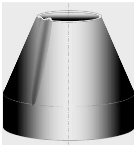
Рис. 1. Возникновение продольной складки в зоне деформации при обжиге тонкостенной трубчатой заготовки
