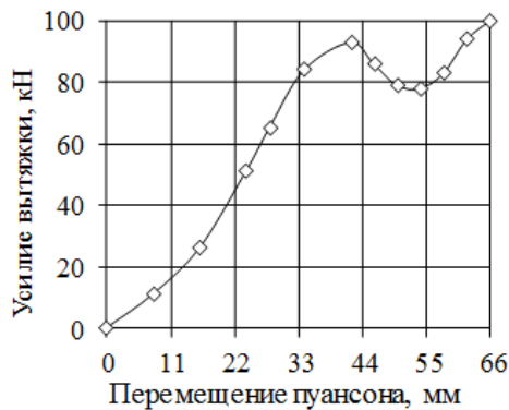
Рис. 8. Расчетная зависимость усилия вытяжки от перемещения пуансона (а) и общий вид полуфабриката в разрезе, полученный вытяжкой (б)
