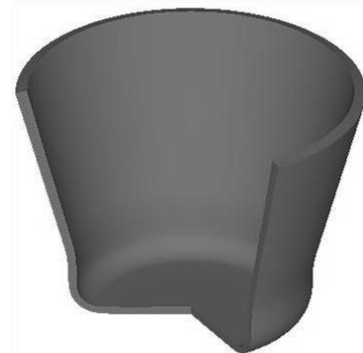
Рис. 8. Расчетная зависимость усилия вытяжки от перемещения пуансона (а) и общий вид полуфабриката в разрезе, полученный вытяжкой (б)
