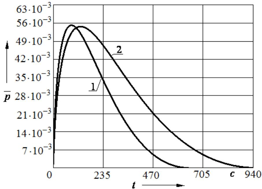
Рис. 7. Зависимости изменения  $\bar{p}$  от  $t$  для алюминиевого сплава АМг6: кривая 1 -  $\xi_e = 0,8 \cdot 10^{-3} \text{ 1/c}$ ; кривая 2 -  $\xi_e = 1,2 \cdot 10^{-3} \text{ 1/c}$  ( $\xi_e = 1 \cdot 10^{-3} \text{ 1/c}$ )
