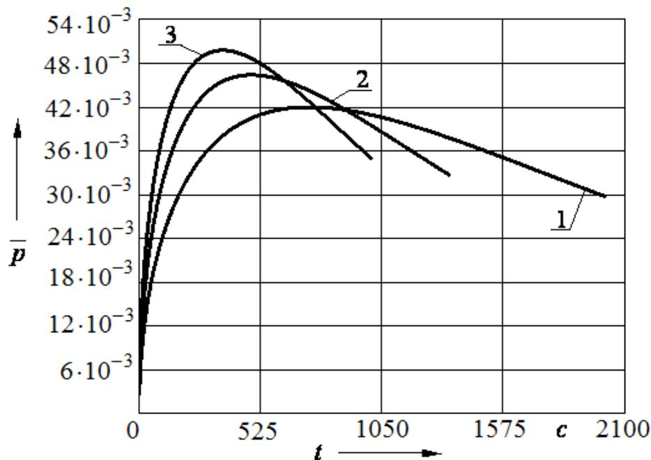
Рис. 6. Зависимости изменения  $\bar{p}$  от  $t$  для алюминиевого сплава АМгб: кривая 1 -  $\xi_e = 0,4 \cdot 10^{-3} \text{ 1/с}$ ; кривая 2 -  $\xi_e = 0,6 \cdot 10^{-3} \text{ 1/с}$ ; кривая 3 -  $\xi_e = 0,8 \cdot 10^{-3} \text{ 1/с}$
