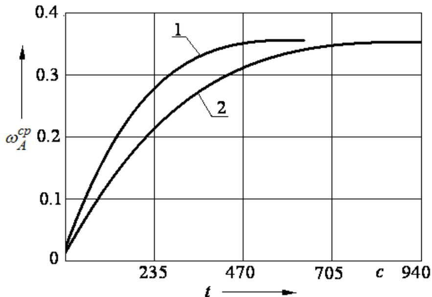
Рис. 8. Зависимости изменения  $\omega_A^{cp}$  от  $t$  для алюминиевого сплава АМг6: кривая 1 -  $\xi_e = 1,2 \cdot 10^{-3} \text{ 1/c}$ ; кривая 2 -  $\xi_e = 0,8 \cdot 10^{-3} \text{ 1/c}$
