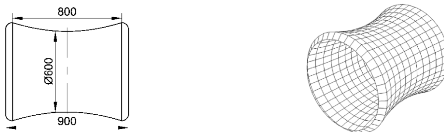
Рис. 2. Профиль валка и его конечно-элементная модель применительно к процессу правки труб на косовалковых трубоправильных машинах
