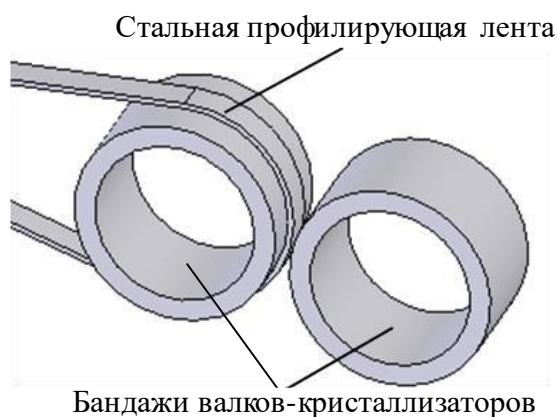
Рис. 1. Схематическое изображение способа профилирования поверхности бандажей валков-кристаллизаторов при помощи стальной профилирующей ленты
