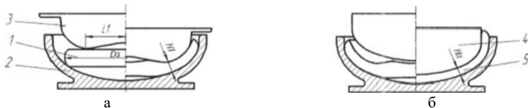
Рис. 6. Способковки днищ локальным деформированием:
