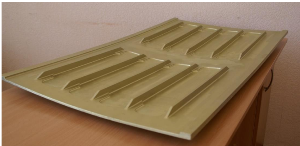
Рис 4. Образец панели двойной кривизны, полученный последовательной местной разводкой с изгибом
