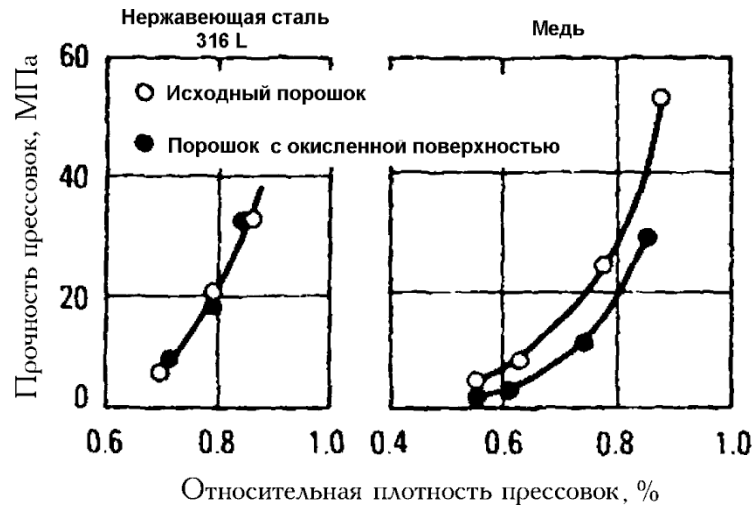
Рис. 5. Влияние поверхностных оксидных пленок на прочность прессовок из порошков меди и нержавеющей стали 316L [19]
