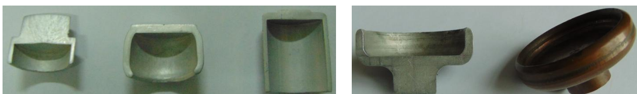
Рис. 7. Полые детали, полученные радиально-прямым выдавливанием с раздачей
