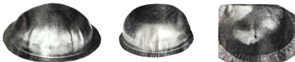
Рис. 1. Отштампованные тонколистовые детали с различными типами потери устойчивости при пневмоударной штамповке жидкостью
