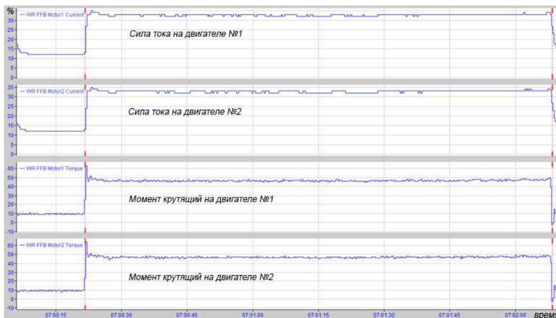
Рис. 1. Скриншот токовых нагрузок и моментов на двигателях блока
