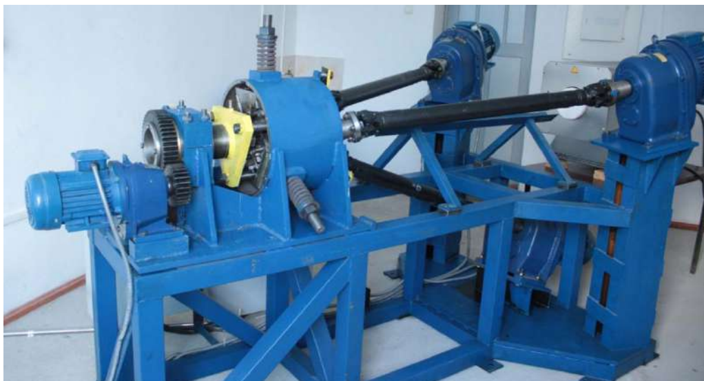
Рис. 1. Стан радиально-сдвиговой прокатки СВП-08
