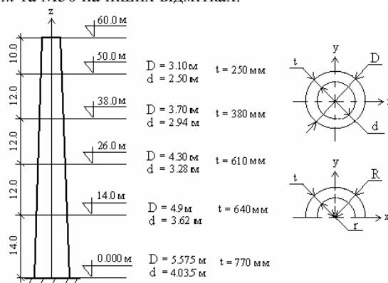
Рис. 1. Конструкція стовбура цегляної димової трубы
