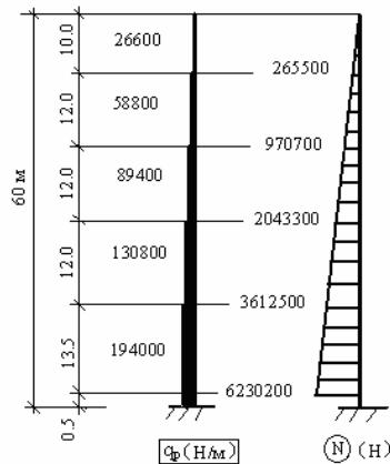
Рис. 4. Навантаження від власної ваги і епюра повздовжніх зусиль
