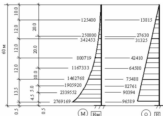
Рис. 3. Епюри згинальних моментів і перерізуючих сил
