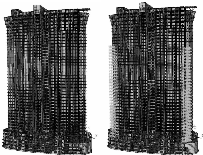
Рис. 3. Идеальная и «фактическая» КЭ-модели высотного здания (цветом выделены отклонения от проекта)
